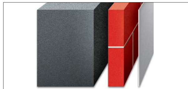
420 мм бетон = 130 мм кирпич = 7 мм pufatherm®
